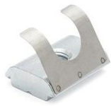
Nutenstein mit Feder B-Typ Nut 10, Gewindedurchmesser M6
