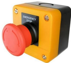
Not Aus Taster Schalter Notaus 1 Öffner + 1 Schließer rastend inklusive Gehäuse
